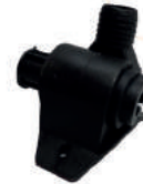
CAIXA DOSADORA SEMENTE FINA COMPLETO APLICAÇÃO: LINHA DE INVERNO
