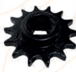
CÓD. RP07080011 RUEDA DENTADA Z 14 CON AGUJERO HEXAGONAL DE 7/8 APLICACIÓN: TRANSMISIÓN
